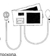
**ПРИМЕЧАНИЕ:** расположение стрелки манометра не по центру нулевой области, обозначенной символом □ не является браком прибора. Стрелка манометра должна находиться в пределах нулевой области, которая устанавливается изготовителем при юстировке прибора в необходимом положении для обеспечения требуемой точности.
