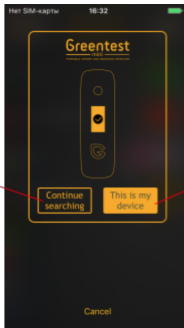
Подтверждение согласования (1 - продолжить поиск Greentest mini, 2 - завершить поиск и сохранить номер текущего устройства)
